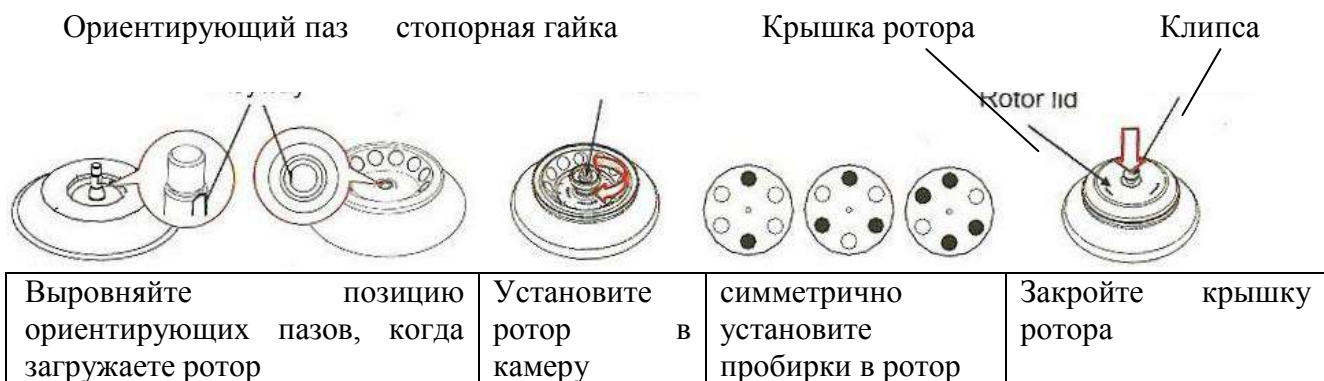
Изображение 8-2 Установка ротора
