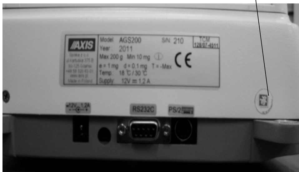
Рисунок 2 – Маркировка и место нанесения пломбы – наклейки, защищающей влагомер от несанкционированного доступа
