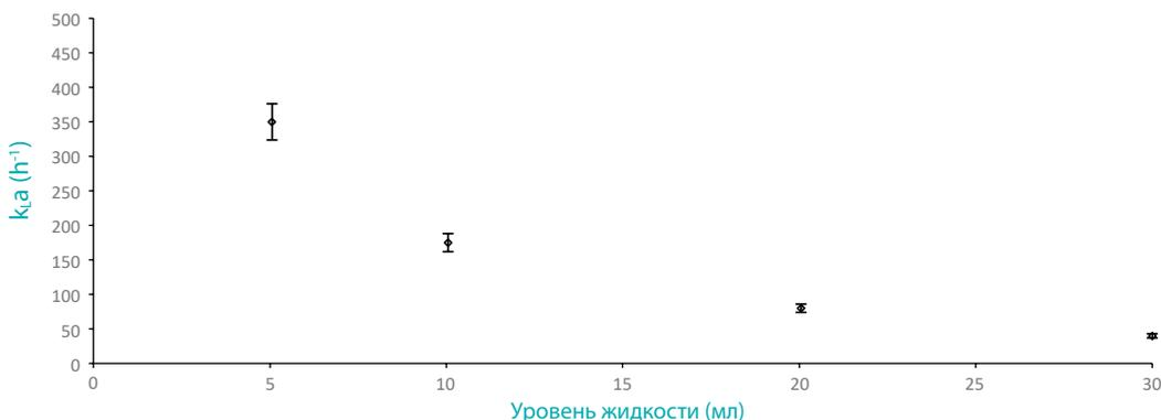
Рис. 3. Влияние различных объёмов среды на скорость ее насыщения кислородом в 50 мл TPP Биореакторе при интенсивном реверсивном вращении на RST-1C. Заполнение осуществляли де-ионизированной водой объёмом 5, 10, 20 и 30 мл и измерения осуществляли не инвазивным O<sub>2</sub> датчиком и оптикой (PreSens, Германия) при 37 °C используя метод полного вытеснения растворенного кислорода-азотом. На Рис. 3 представлены средние значения как минимум 5 экспериментов а также их среднеквадратичные отклонения.
