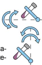
Когда иконка пробирки расположена горизонтально, возвратно-поступательное движение платформы начинается с горизонтального положения пробирок (вертикального положения платформы).
