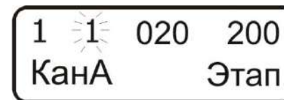
Рисунок 7 – Вид цифрового табло пульта при установке номера этапа
