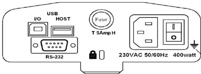
На задней панели находятся разъёмы интерфейсов передачи данных, гнездо предохранителя, крепление для замка и разъём кабеля питания.
