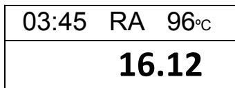
Если функция быстрого разогрева (RAPID) была активирована, на дисплее перед значением температуры будет отображён значок “RA”.
