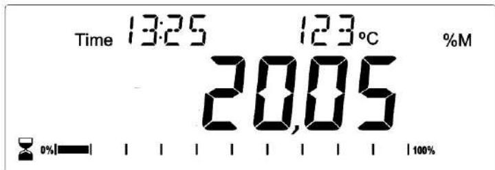
Измерение длится 13 минут и 25 секунд, в данный момент температура 123°C, процент влаги 20.05%, измерение продолжается.
