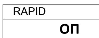
При помощи кнопок **[Dspl/** или **[Test/** выберите нужный вариант установки, затем нажмите кнопку **[Enter]** для продолжения измерения.
