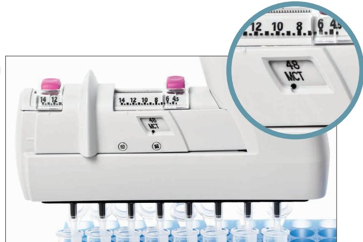
В окошке эквалайзера установлено значение '48 МСТ' для переноса проб в микроцентрифужные пробирки или в 48-луночные микропланшеты
