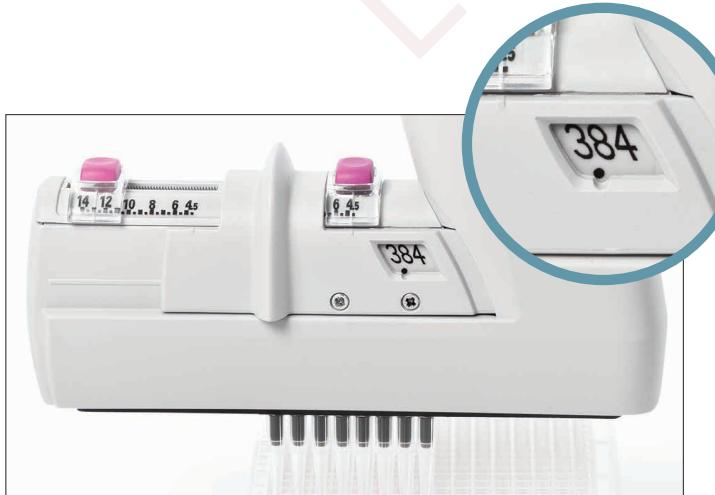
В окошке эквалайзера установлено значение '384' для переноса проб в 384-луночный микропланшет
