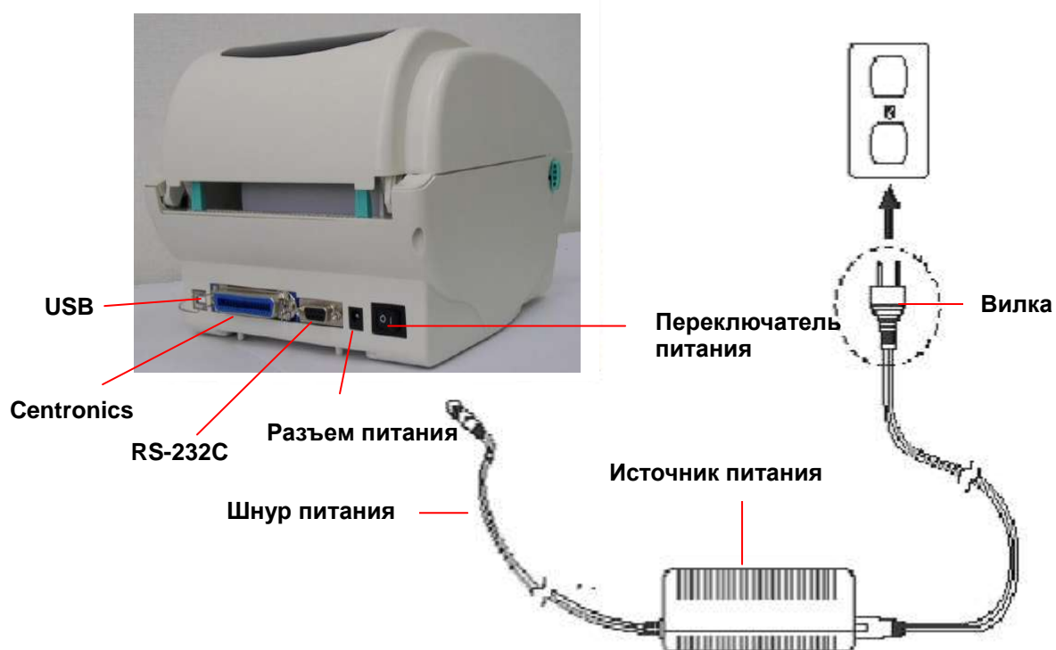
Рис. 5. Подключение источника питания к принтеру
