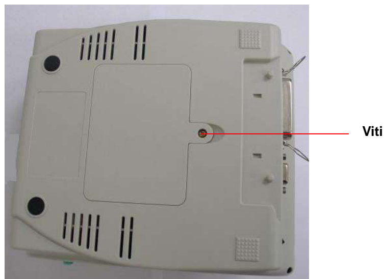
Рис. 15. Отверните 1 винт на нижней части
