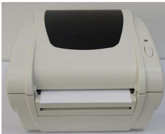
Рис. 8. Полностью закройте верхнюю крышку
