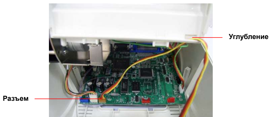
Рис. 16. Прокладка жгута проводов модуля резака
