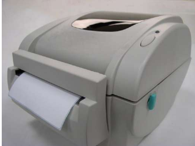
Рис. 19. Заправка этикетки в режиме резака завершена
