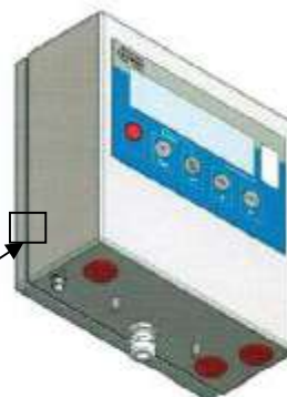
Рисунок 3 - Схема пломбирования от несанкционированного доступа весов технических WPT с индикатором в корпусе из нержавеющей стали.
