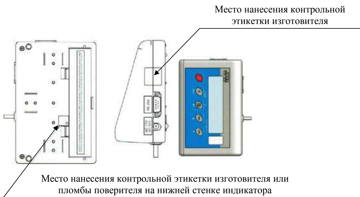
Рисунок 2 - Схема пломбирования от несанкционированного доступа весов технических WPT с индикатором в корпусе из ударопрочного пластика.
