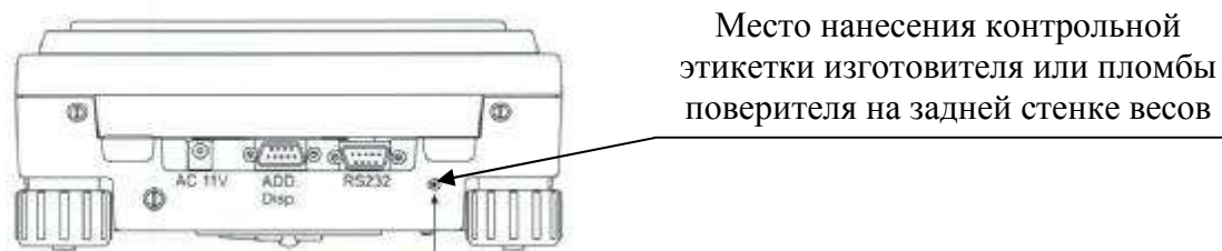
Рисунок 1 - Схема пломбирования от несанкционированного доступа весов технических WLC.
