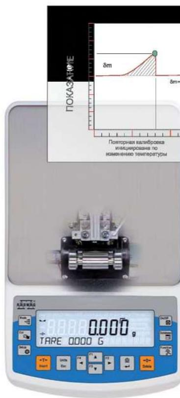
Какие бы ни происходили изменения при эксплуатации весов, внутренняя калибровка позволяет компенсировать влияние этих изменений на точность измерения
