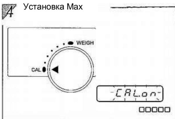
Мягко поверните калибровочную ручку до упора против часовой стрелки. Встроенная гиря создаст необходимую нагрузку на датчик внутри весов. Сообщение [CAL. on] начнет мигать.
