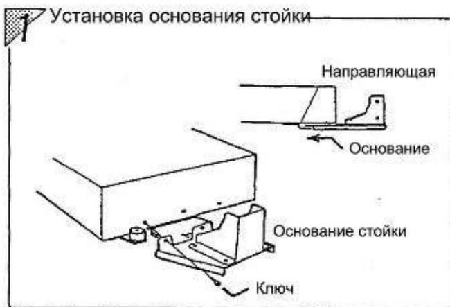
Установите основание стойки в направляющую в нижней части весов и закрепите его с помощью L-образного ключа.
