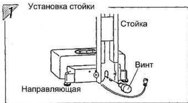
Установите стойку на направляющую и зафиксируйте ее винтом.
