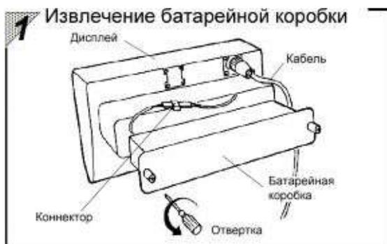
Снимите батарейную коробку, открутив винты на ее задней части. Аккуратно отсоедините коннектор.
