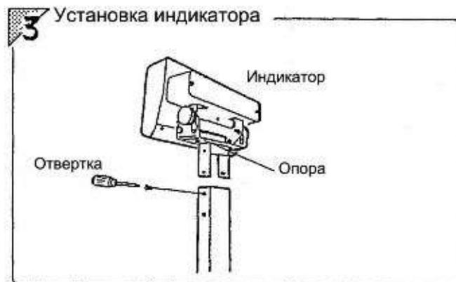
Установите и закрепите индикатор на стойке. Подключите кабель. При использовании питания от сети подключите силовой кабель.
