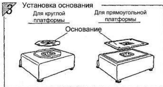
Установите основание платформы и закрепите его с помощью винтов, закрепив их плоской отверткой или монеткой.
