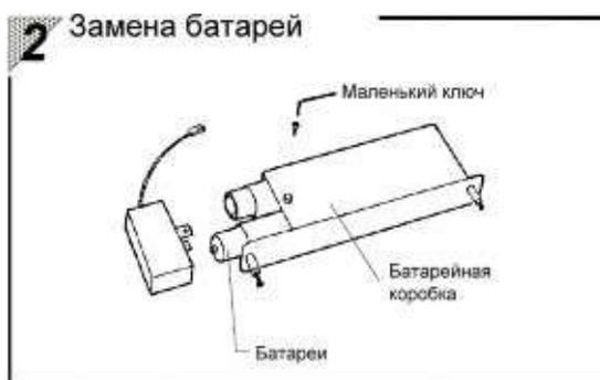
Откройте крышку батарейной коробки, используя входящий в комплект ключ. Установите новые батареи, соблюдая полярность. Закройте крышку батарейной коробки.
