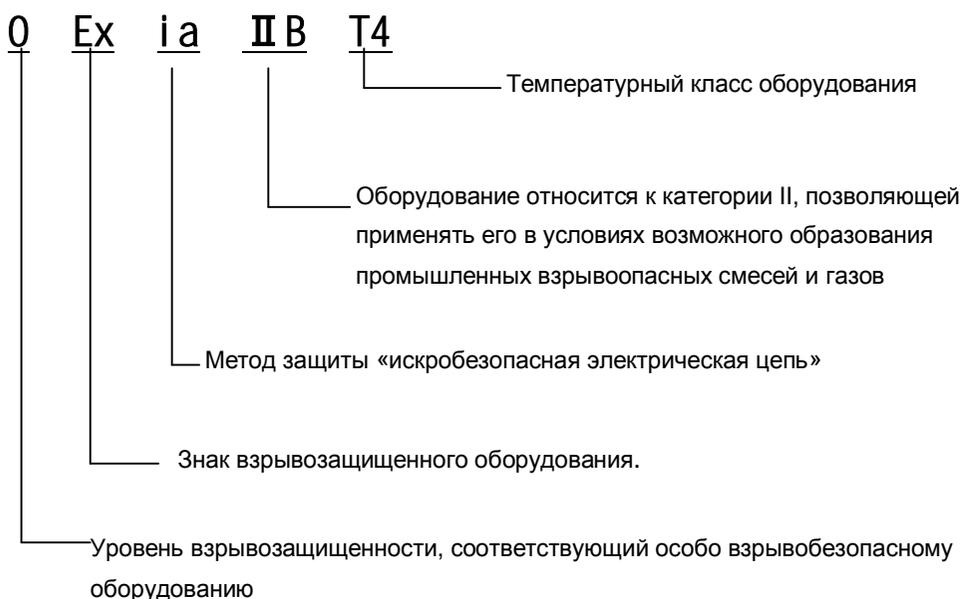
Знак «X», следующий за маркировкой взрывозащиты означает, что замена батарей электропитания весов допускается только вне взрывоопасной зоны.
