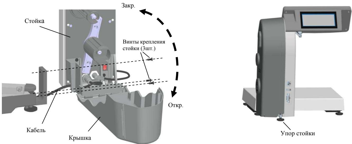
Рис. 2.3 – Крепление терминалов в весах MK-RL, MK-R2L
