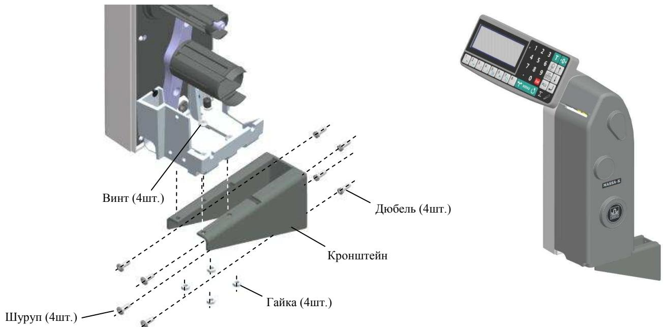
Рис. 2.5 – Крепление терминалов на стене
