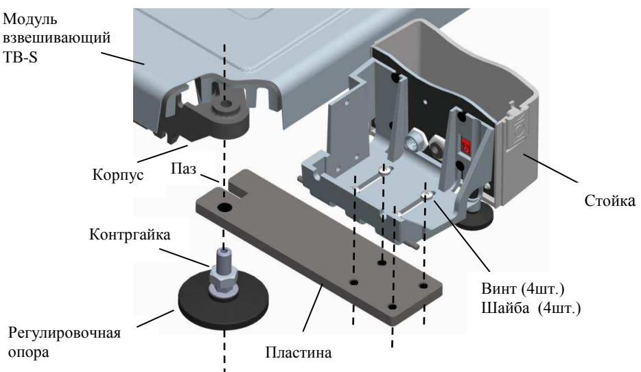
Рис. 2.4 – Крепление терминалов к модулю взвешивающему ТВ
