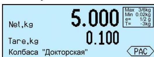
После снятия товара и тары с платформы, терминал покажет массу Net, равную массе тары, со знаком минус.
