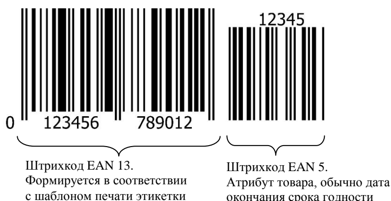
Рис. 7.2 – Структура штрихкода EAN 13+5
