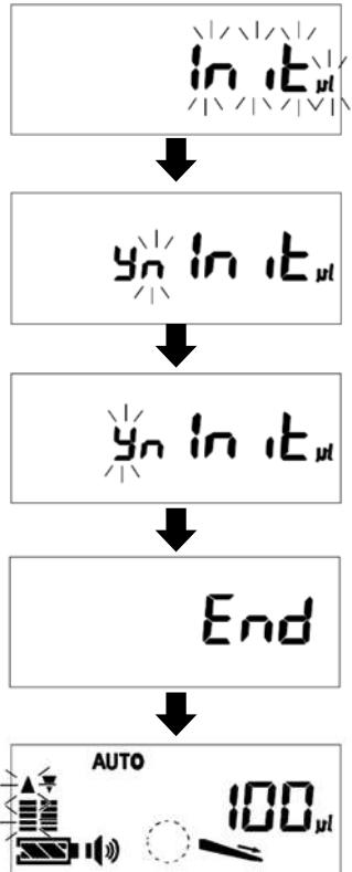
[ 3 ] Нажмите клавишу «Вверх» или «Вниз» для перехода к режиму сброса установленных значений калибровки объема.
