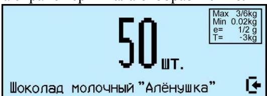
При использовании счетной функции допускается тарирование кнопкой
