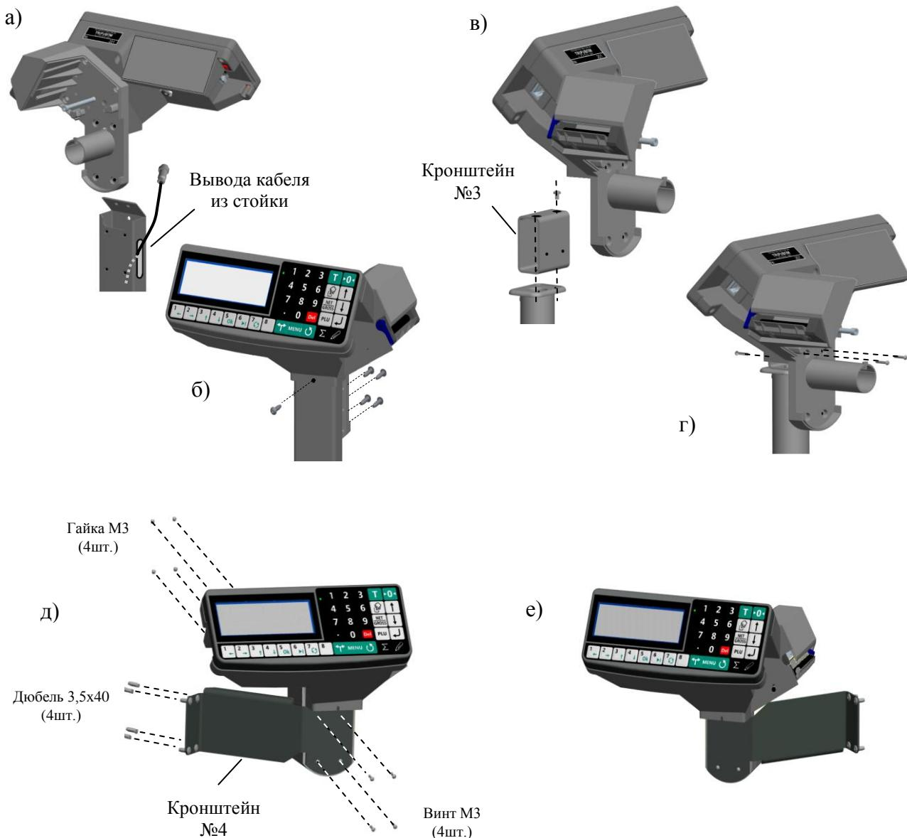
Рис. 2.2 - Варианты крепления терминалов RP и R2P:
