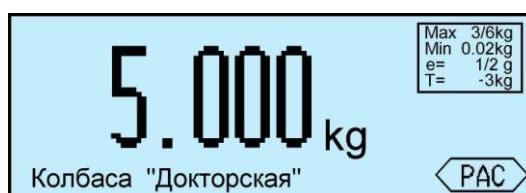
⌚ При ненагруженной платформе, индикатор должен показывать нулевую массу, в противном случае нажать кнопку **•0•**.
