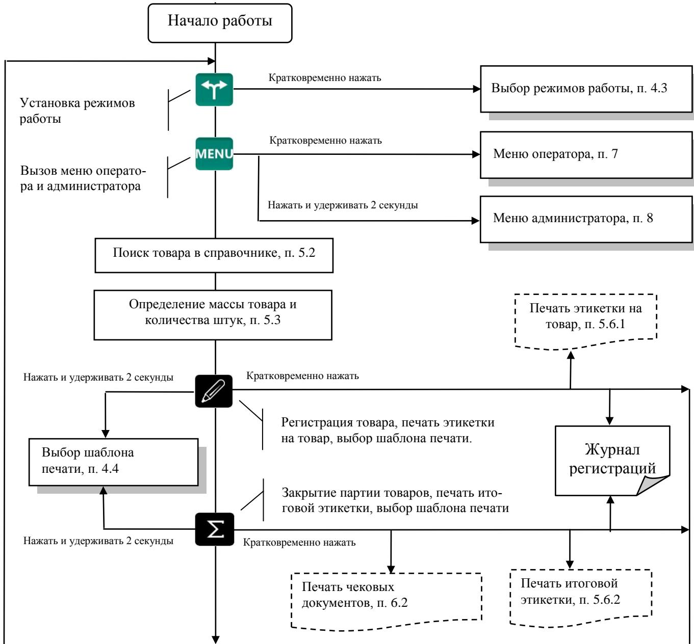
Рис. 3.1 – Схема работы терминала RP (R2P)
