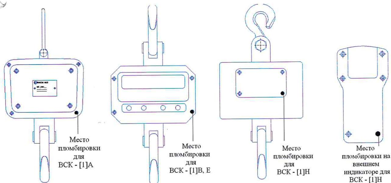
Рисунок 3 - Схема пломбировки весов ВСК от несанкционированного доступа
