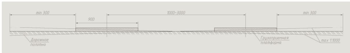
Рисунок 3.2 Схема установки грузоприемных платформ в поперечном направлении
