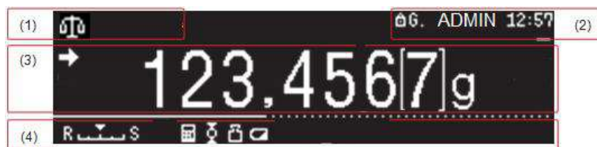
Рисунок 4 – Дисплей весов (изображение для режима стандартного взвешивания)
