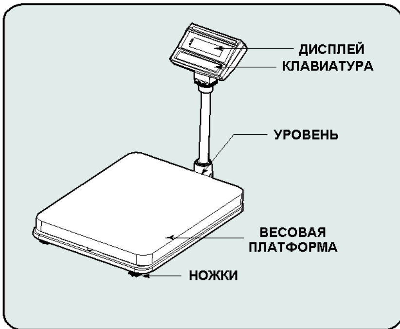
Рис. 5.1 - Внешний вид и основные элементы весов HD
