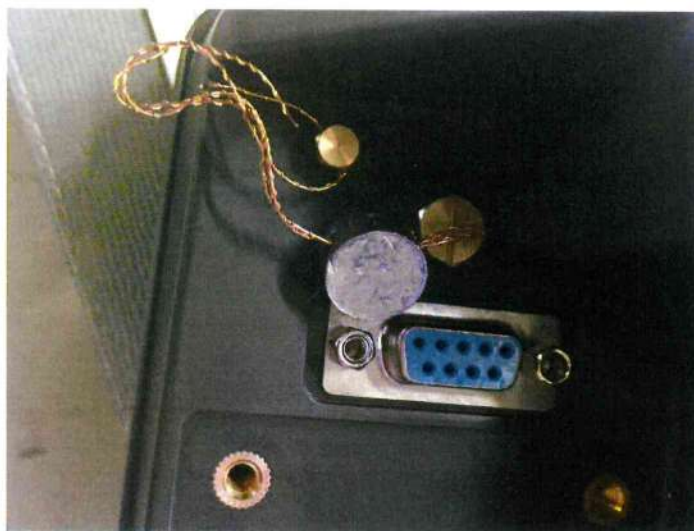
Рисунок 2 – Место пломбировки весов
