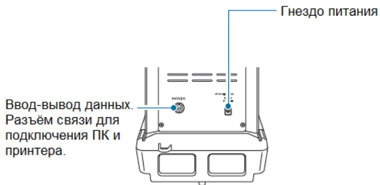
Рисунок 2 - Задняя панель весов
