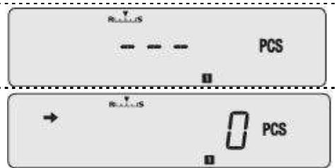
Если масса единицы образца уже была установлена: на дисплее отобразится «0<sup>PCS</sup>»
