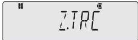
Если функция слежения за нулем включена, на дисплее под знаком слежения за нулем появляется символ стабилизации (→).
