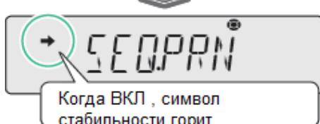
**4 Установите работу с клавишами:** могут ли начало и окончание непрерывного выхода производиться вручную с помощью клавиш.
