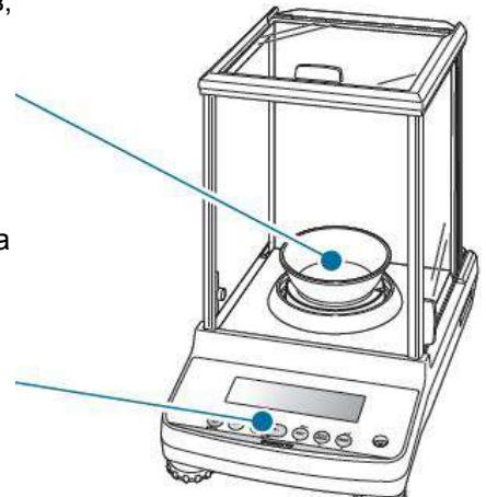
**3.1.3** Как только показания стабилизируются (появление на дисплее символа стабилизации означает, что показания стабильны), нажмите клавишу **→0/T←** и на дисплее весов отобразится ноль.
