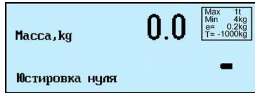
7.2.3.3 Юстировка модулей весов **паллетных** (4D-U\_) и модулей весов **стержневых** (4D-B\_) завершена.
