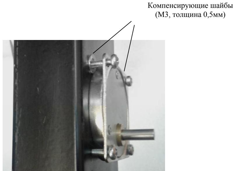
Рис. 7.17 - Блок подмотки
