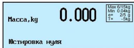
☞ Кнопку ↪ нажимать после завершения взвешивания. Индикацией завершения является высвечивание на индикаторе сообщения: «Масса, kg».
