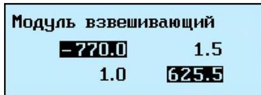
В). Неисправность. Один из датчиков установлен с другой грузоподъемностью. Из теста видно, что датчик DLC-4D-750, следует заменить на DLC-4D-500.
