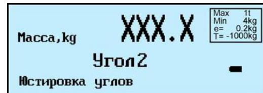
Снять гири с платформы.
